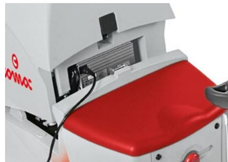
Sur demande, l'Innova 55 B peut être équipée d'un chargeur de batterie incorporé afin de rendre la recharge plus rapide, plus sûre et plus simple
